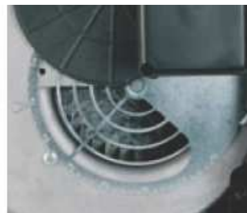
Vzduchová klapka kompletně otevřena
