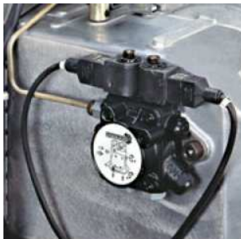
Příklad hydraulického obvodu na hořáku RL 32 BLU
